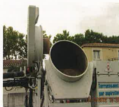
Aspiratrice/excavatrice utilisée lors d'une casse de conduite sur Lattes en octobre 2012
