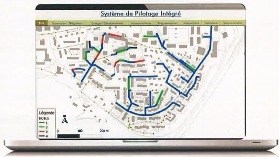
Exemple de représentation de tronçons à inspecter ou à renouveler générée par Octave
