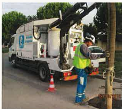
Aspiratrice/excavatrice utilisée lors d'une casse de conduite sur Lattes en octobre 2012
